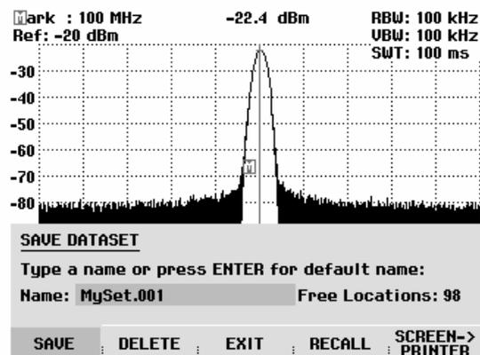
Durch Drücken der BACK-Taste blättert der R&S FSH durch die Liste der Namen der bereits vorhandenen Datensätze und zeigt diese mit der ersten freien Erweiterung an. Damit kann zum Beispiel der Name des zuletzt aufgerufenen Datensatzes gewählt werden, um die Messergebnisse abzuspeichern.
