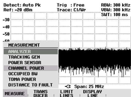
Der R&S FSH zeigt das Softkeymenü zur Einstellung der Kanalleistungsmessung an. Im Messdiagramm zeigt er durch zwei senkrechte Linien die Kanalbandbreite an. Die gemessene Kanalleistung zeigt er im Messwertdiagramm unten groß an.
