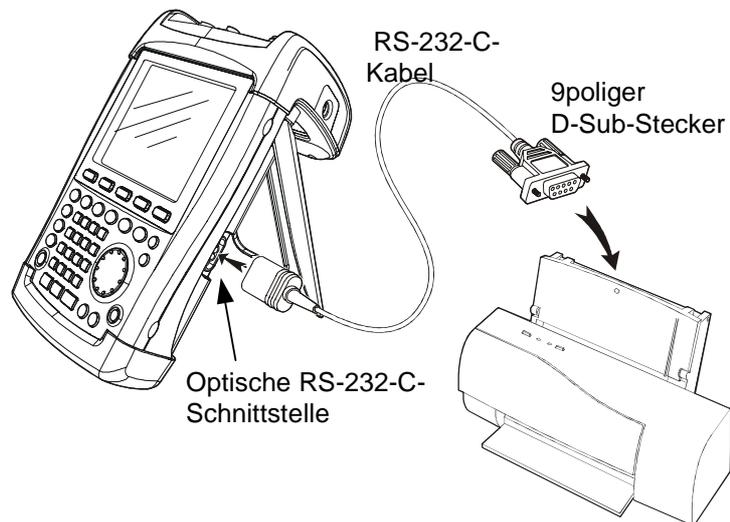
Drucker mit Parallelschnittstelle sind über den Seriell-Parallel-Konverter R&S FSH-Z22 an den R&S FSH anzuschließen. Dieser stellt die Centronis-Parallelschnittstelle zum Anschluss eines Druckers zur Verfügung. Die Versorgung des R&S FSH-Z22 erfolgt über eine 9-V-Alkali Batterie (NEDA, IEC6LR61).
