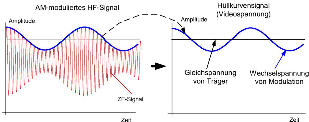
Das Hüllkurvensignal enthält einen Gleichanteil, der dem Trägerpegel entspricht und einen Wechselanteil, der der AM-Modulation entspricht. Wenn die Bandbreite des Videofilters kleiner ist als die Frequenz des Wechselanteils, wird dieser abhängig von dessen Grenzfrequenz unterdrückt. Um den AM-Anteil unverfälscht anzuzeigen, muss also die Grenzfrequenz höher sein als die Modulationsfrequenz.
