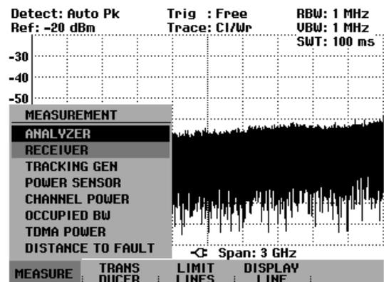
Der R&S FSH schaltet den Empfängermodus ein und misst den Pegel auf der eingestellten Frequenz.
