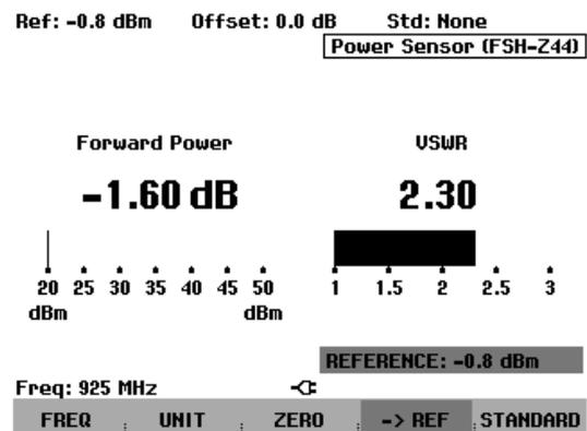
Zur genauen Messung von modulierten Signalen bietet der R&S FSH die Berücksichtigung von Korrekturwerten für einige gebräuchliche Übertragungsstandards an.
