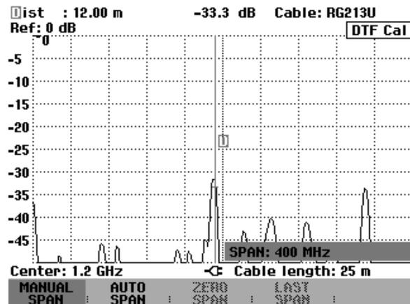
Messung mit automatischer Einstellung des Spans      Messung mit 400 MHz Span
