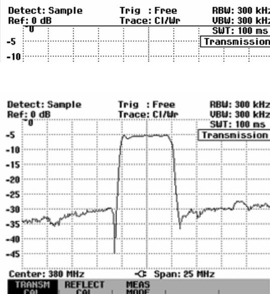
Die Durchgangskalibrierung bleibt solange erhalten, bis die Mittenfrequenz oder der Darstellbereich des R&S FSH geändert wird. Bei Verlust der Kalibrierung meldet er **Track Gen Uncal** oben rechts am Bildschirm.
