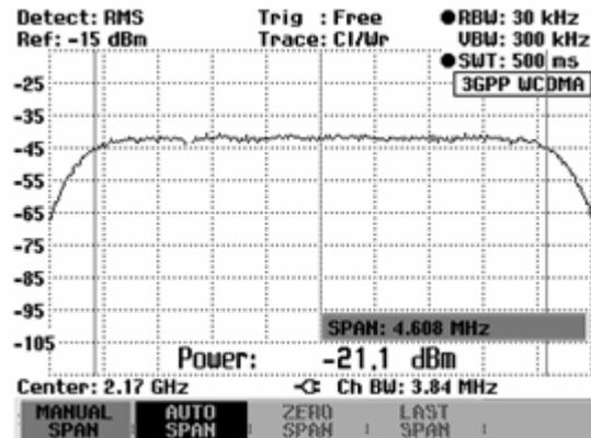
Der größte zugelassene Frequenzdarstellbereich bei der Kanalleistungsmessung ist das Zehnfache der Kanalbandbreite. Bei größeren Frequenzdarstellbereichen wäre das Ergebnis der Kanalleistungsmessung zunehmend ungenau, da zu wenige Punkte der Messkurve in den zu messenden Kanal fallen.
