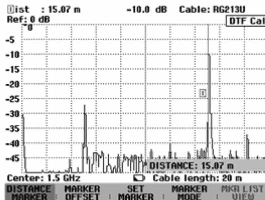
Für eine höhere Auflösung einer Fehlstelle bietet der R&S FSH eine Zoomfunktion an der Stelle des Markers an. Die x-Achse des Displays kann bis auf 3 Meter Darstellbereich gedehnt werden.
