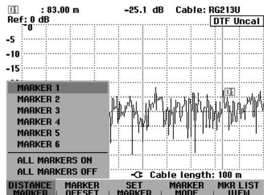
Nachdem ein Marker eingeschaltet wurde, zeigt der R&S FSH dessen Position im Werteingabefeld an. Diese kann nun durch Eingabe eines Abstands mit den Zifferntasten (z.B. 11.5 m), durch pixelweise Bewegung des Markers mit dem Drehknopf oder mit den Cursortasten in 10%-Schritten der dargestellten Kabellänge bewegt werden. Zur schnellen Positionierung des Markers an eine bestimmten Stelle ist die Grobeinstellung mit den Cursortasten und anschließende Feineinstellung mit dem Drehrad empfehlenswert.
