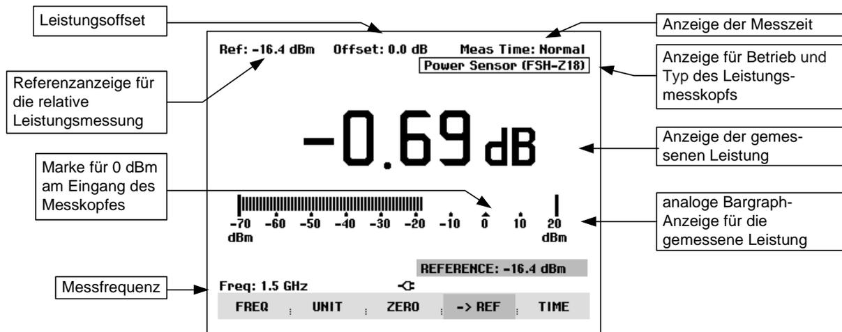
Der Leistungsmesskopf enthält frequenzabhängige Korrekturwerte. Damit erreicht er bei Signalen mit bekannter Frequenz die höchste Genauigkeit. Beim Umschalten von einer anderen Betriebsart in den Leistungsmessbetrieb übernimmt der R&S FSH die Mittenfrequenz als Frequenz für den Leistungsmesskopf.
