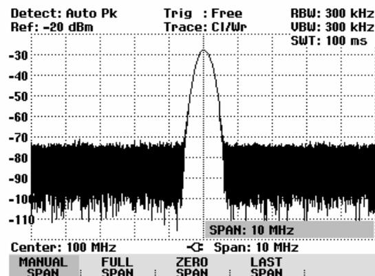
Um den gesamten Frequenzbereich von 0 Hz bis 3 GHz (R&S FSH3) bzw. 0 bis 6 GHz (R&S FSH6) auf Knopfdruck einzustellen, ist der Softkey FULL SPAN vorgesehen.
