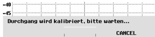
Nach Beendigung der Kalibrierung gibt der R&S FSH oben rechts im Diagramm **Transmission** aus. Dies dient als Hinweis, dass er zur Messung der Übertragungsfunktion kalibriert ist. Zusätzlich ist die Softkeybeschriftung TRANSM CAL grün hinterlegt.
