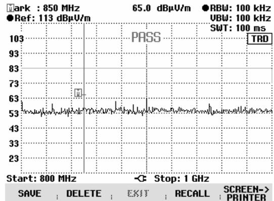
➤ Der Softkey SCREEN->PRINTER startet den Ausdruck des Bildschirminhaltes auf dem angeschlossenen Drucker.
