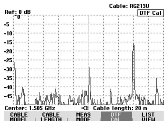
Alternativ zur Rückflussdämpfung kann der R&S FSH auch das VSWR der Fehlstellen anzeigen. Die Umschaltung auf VSWR-Darstellung erfolgt mit der Taste AMPT.
