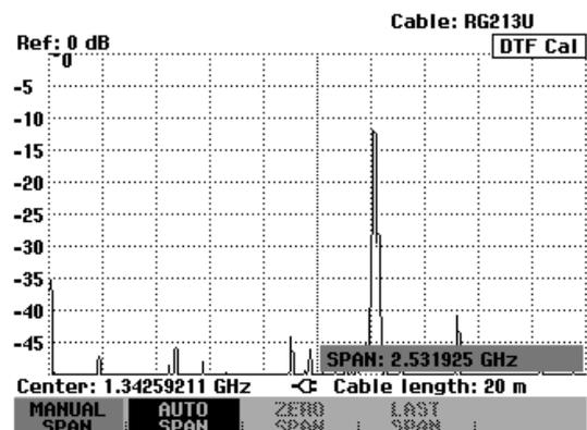
Der minimal einstellbare Span ist 1/10 des automatisch bei AUTO SPAN vom R&S FSH eingestellten Spans oder 200 MHz (der jeweils kleinere Wert). Grössere Spans als die bei AUTO SPAN vom R&S FSH eingestellte sind nicht zugelassen. Beim Versuch kleinere oder größere Spans einzustellen meldet der R&S FSH „Minimum erreicht“ bzw. „Bereichsüberschreitung“.
