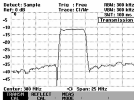
Die Durchgangskalibrierung bleibt solange erhalten, bis die Mittenfrequenz oder der Darstellbereich des R&S FSH geändert wird. Bei Verlust der Kalibrierung meldet er **Track Gen Uncal** oben rechts am Bildschirm.
