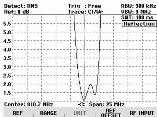
Die Kalibrierung der Reflexion bleibt solange erhalten, bis die Mittenfrequenz oder der Darstellbereich des R&S FSH geändert wird. Bei Verlust der Kalibrierung meldet er **Track Gen Uncal** oben rechts am Bildschirm.
