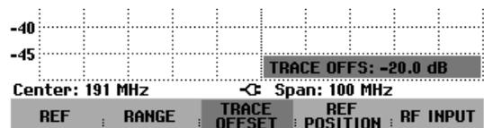
Der Trace-Offset ist dann nützlich, wenn z. B. eine feste Dämpfung oder Verstärkung bei der Messung ausgeglichen werden soll.
