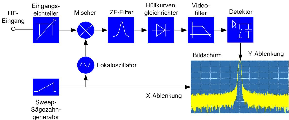
Der Eichteiler am Eingang des Spektrumanalysators passt den Pegel des Mess-Signals an den Pegelbereich an, den der Mischer verarbeiten kann, ohne dass er übersteuert wird. Beim R&S FSH ist der Eingangseichteiler in 10-dB-Schritten von 0 bis 30 dB schaltbar und direkt an die Einstellung des Referenzpegels gekoppelt.
