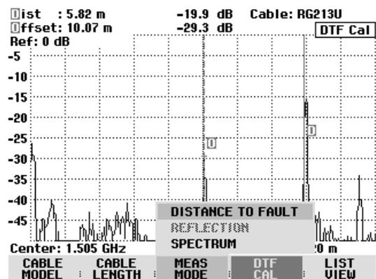
Mit der Einstellung SPECTRUM schaltet der R&S FSH den Mitlaufgenerator aus und stellt das Spektrum im Frequenzbereich der DTF-Messung dar. Als Hinweis, dass der R&S FSH in der Spektrumsdarstellung arbeitet, gibt er oben rechts am Bildschirm
