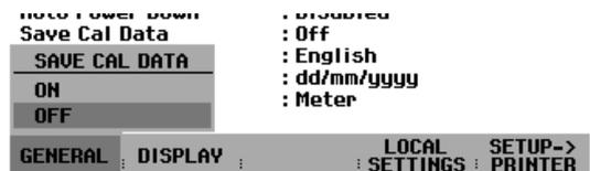
Der Zustand der Kalibrierdatenspeicherung ist im Menü SETUP eingetragen.
