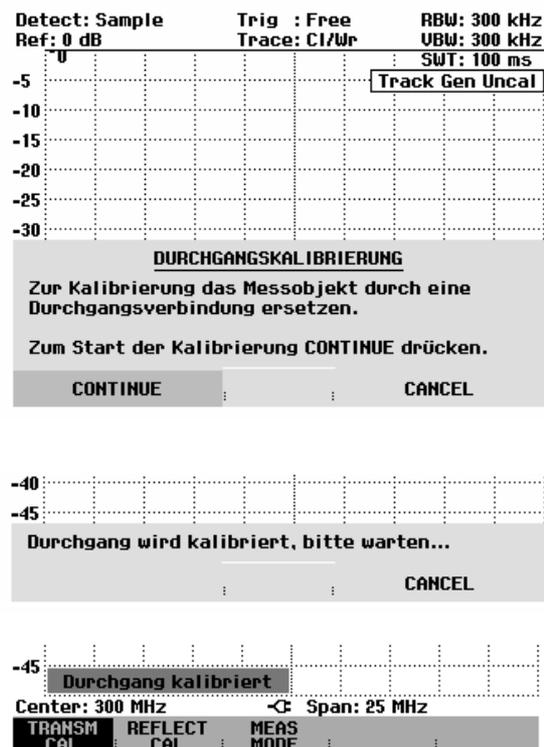
Nach Beendigung der Kalibrierung gibt der R&S FSH oben rechts im Diagramm **Transmission** aus. Dies dient als Hinweis, dass er zur Messung der Übertragungsfunktion kalibriert ist. Zusätzlich ist die Softkeybeschriftung TRANSM CAL grün hinterlegt.
