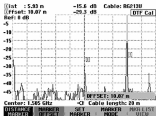
Wie bei der Spektrumanalyse bietet der R&S FSH Funktionen an, um den Marker oder den Marker Offset auf der Messkurve automatisch zu positionieren. Diese sind unter dem Softkey SET MARKER zusammengefasst.
