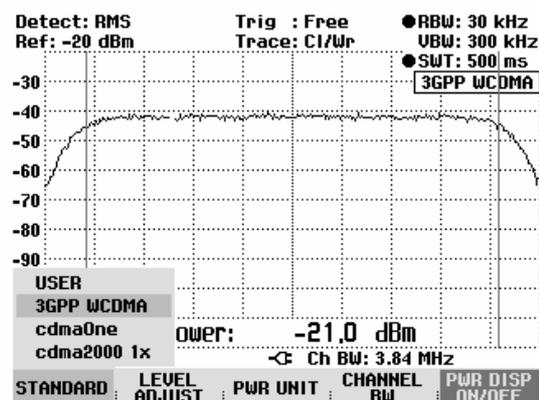
Mit der Auswahl von USER stellt der R&S FSH die zuletzt mit USER verwendete Einstellung für die Kanalleistungsmessung wieder ein. Änderungen in den Einstellungen übernimmt er automatisch, so dass sie beim nächsten Aufruf des Standards USER wieder verfügbar sind.
