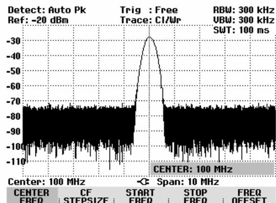
Die Abstimmung der Mittenfrequenz mit dem Drehrad erfolgt in Pixel-Schrittweite, d. h. die Mittenfrequenz wird pro Abstimmschritt mit ca. 1/300 des Frequenzdarstellbereichs geändert. Mit den Cursor-Tasten erfolgt die Abstimmung in Schritten von 10 % des Frequenzdarstellbereichs (= 1 Gridrastrer). Wenn davon abweichende Abstimmsschritte notwendig sind, können diese mit der Funktion **CF STEPSIZE** (= Mittenfrequenz-Schrittweite) definiert werden.
