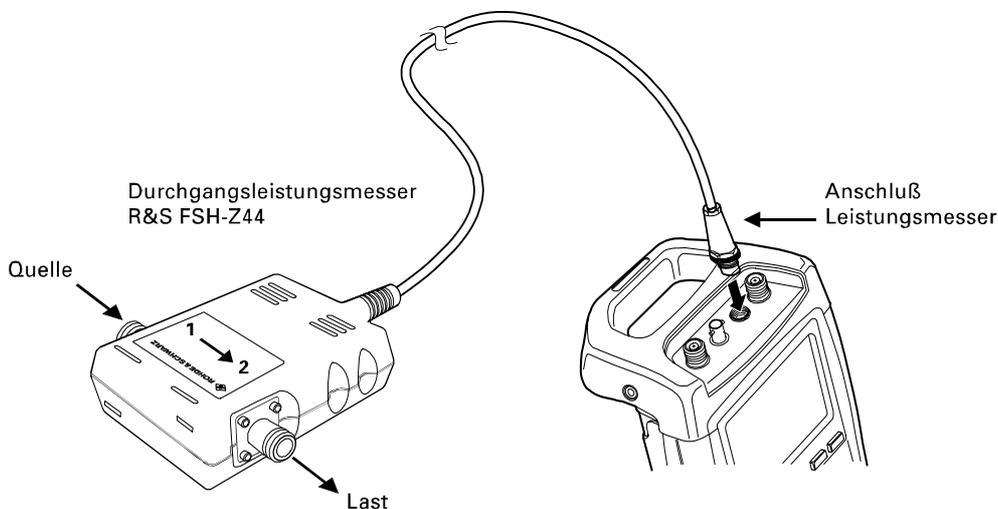
Bei der Messung von hohen Leistungen sind die folgenden Anweisungen strikt zu befolgen, um die Zerstörung des Leistungsmessers oder Schaden an Personen abzuwenden:
