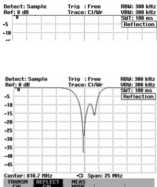
Die Durchgangskalibrierung bleibt solange erhalten, bis die Mittenfrequenz oder der Frequenzdarstellungsbereich des R&S FSH geändert wird. Bei Verlust der Kalibrierung meldet er **Track Gen Uncal** oben rechts am Bildschirm.
