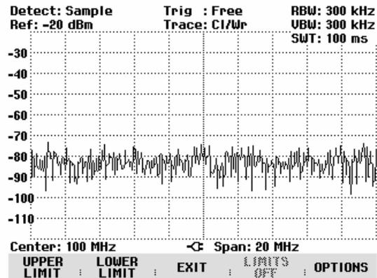
Der R&S FSH zeigt die Liste der verfügbaren Grenzwertlinien an. Wenn noch keine Grenzwertlinie eingeschaltet ist, ist der erste Grenzwert der Liste hinterlegt. Bei einer bereits eingeschalteten Grenzwertlinie, steht der Auswahlcursor auf dem entsprechenden Eintrag. Wenn keine Grenzwertlinie im R&S FSH gespeichert ist, erscheint die Meldung 'NO LIMIT LINES'.
