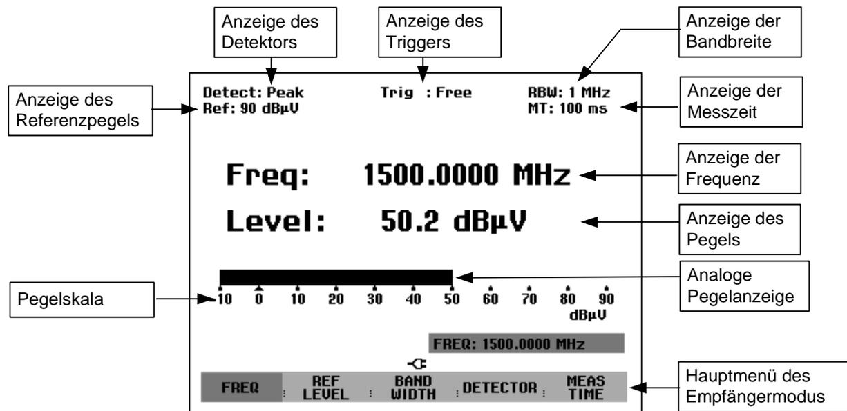
Der R&S FSH bietet die wichtigsten Einstellparameter wie Frequenz, Referenzpegel, Messbandbreite, Detektor und Messzeit im Hauptmenü des Empfängermodus an. Sie sind aber auch über die entsprechenden Tasten einstellbar.
