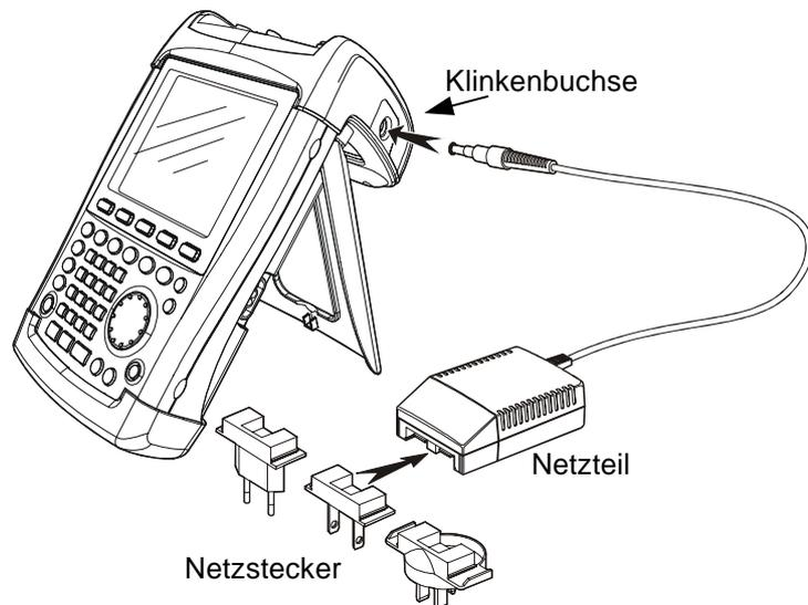
Für eine schnelle Aufladung der Batterie ist dringend zu empfehlen das Gerät während des Ladevorgangs auszuschalten. Die Ladezeit beträgt etwa 4 Stunden.
