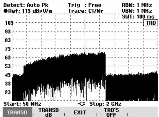
Mit dem Softkey TRANSD dB ist ein zweiter Transducerfaktor einschaltbar, den der R&S FSH zum ersten addiert. Die Einheit des zweiten Transducerfaktors muss dazu immer die relative Einheit dB haben. Ansonsten wäre eine Addition nicht sinnvoll. Der R&S FSH bietet daher bei der Auswahl von TRANSD DB nur die im Gerät gespeicherten Transducerfaktoren mit der Einheit dB an.
