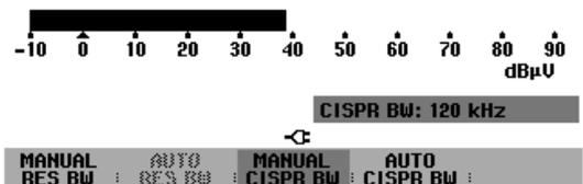
Es stehen die Bandbreiten 200 Hz, 9 kHz, 120 kHz und 1 MHz zur Verfügung.
