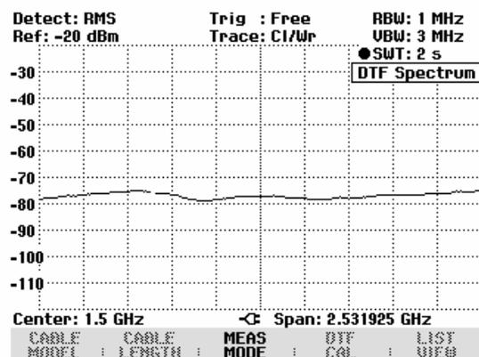
Mit der Einstellung REFLECTION misst der R&S FSH die Reflexionsdämpfung in dem Frequenzbereich, in dem er auch die Kabelstellenmessung durchführt. Dadurch kann zum Beispiel die Anpassung einer Antenne ohne Wechsel des Messaufbaus durchgeführt werden. Der R&S FSH schaltet die Messbrücke R&S FSH-Z2 automatisch auf VSWR-Messung um, wenn REFLECTION gewählt ist.
