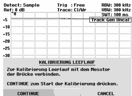
Nach Abschluss der Leerlaufkalibrierung fordert der R&S FSH in einer Meldung das Messtor auf, mit einem Kurzschluss abzuschließen.
