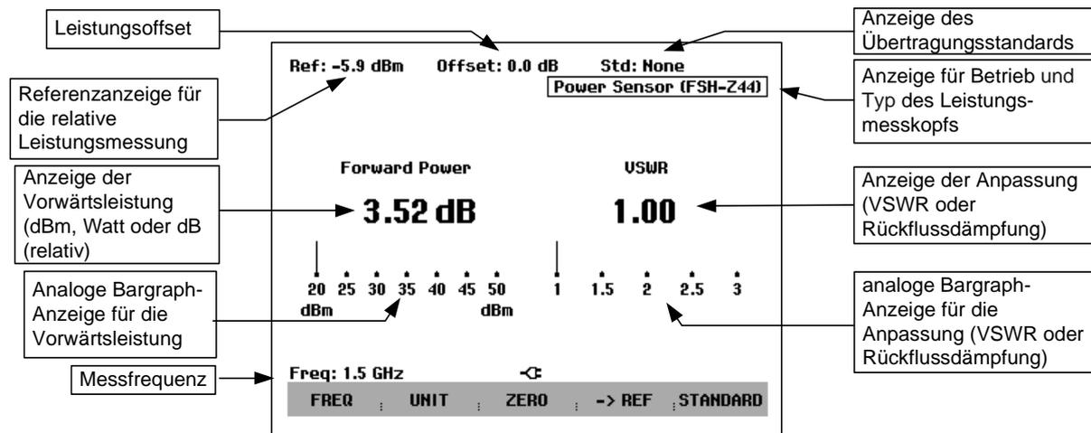
Der Leistungsmesskopf enthält frequenzabhängige Korrekturwerte. Damit erreicht er bei Signalen mit bekannter Frequenz die höchste Genauigkeit. Beim Umschalten von einer anderen Betriebsart in den Leistungsmessbetrieb übermittelt der R&S FSH seine Mittenfrequenz an den Leistungsmesskopf.
