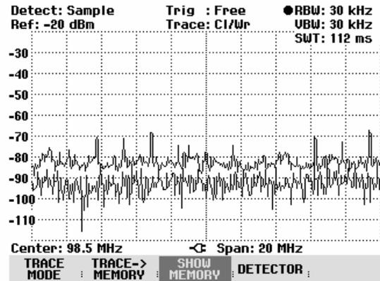
*Hinweis:* Die Messkurve im Speicher (Memory Trace) legt der R&S FSH im Bildspeicher als Bitmap ab. Er passt daher die Speicherkurve nicht an einen geänderten Referenzpegel oder Frequenzdarstellbereich an.
