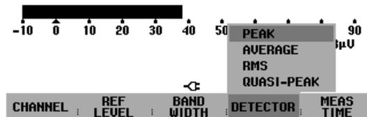
Der R&S FSH öffnet das Menü zur Auswahl des Detektors.
