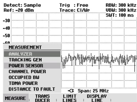
Der R&S FSH öffnet den Bildschirm für die Leistungsmessung. Wenn kein Leistungsmesskopf angeschlossen ist, zeigt er keinen Messwert an. Wenn ein Leistungsmesskopf angeschlossen ist nimmt er über die Schnittstelle Verbindung zum Leistungsmesskopf auf und zeigt nach einigen Sekunden den Typ des angeschlossenen Leistungsmessers (R&S FSH-Z44) und die gemessene Leistung an.
