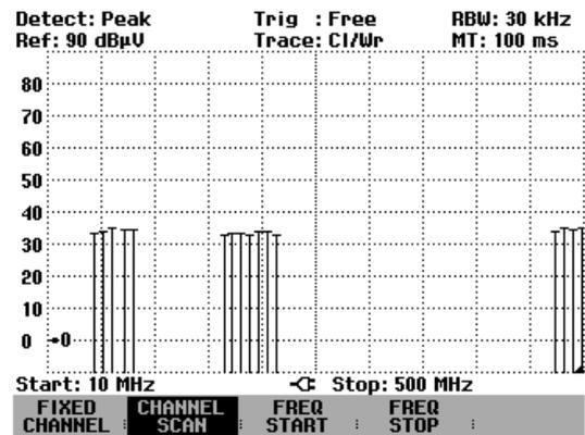
Die verwendete Kanaltabelle kann mit der Taste **FREQ** und dem Softkey **CHANNEL TABLE** angezeigt werden. Sie ist in der Tabelle der Kanaltabellen rot hinterlegt.
