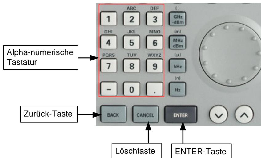
Wenn der R&S FSH eine Eingabe von Buchstaben erwartet, belegt er die Tasten der alphanumerischen Tastatur automatisch mit den oberhalb den Tasten ausgewiesenen Buchstaben. Die Tasten sind dabei mehrfach belegt. Die Eingabe des gewünschten Buchstabens erfolgt, indem man die entsprechende Taste mehrfach drückt.
