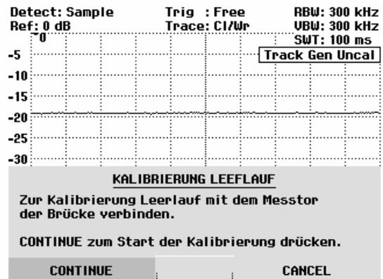
Nach Beendigung der Leerlaufkalibrierung fordert der R&S FSH zur Kurzschlusskalibrierung auf.
