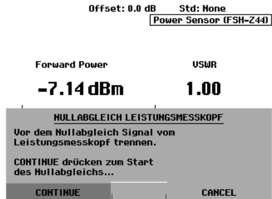
Der R&S FSH stößt unmittelbar den Nullabgleich des Leistungsmesskopfs an. Während des Nullabgleichs meldet der R&S FSH "Nullabgleich Leistungsmesskopf, bitte warten...".
