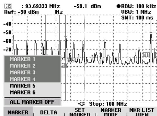
*Hinweis: Wenn die Marker ausgeschaltet werden, schaltet der R&S FSH auch alle Delta-Marker aus, da sich alle Delta-Marker auf den Marker 1 beziehen.*
