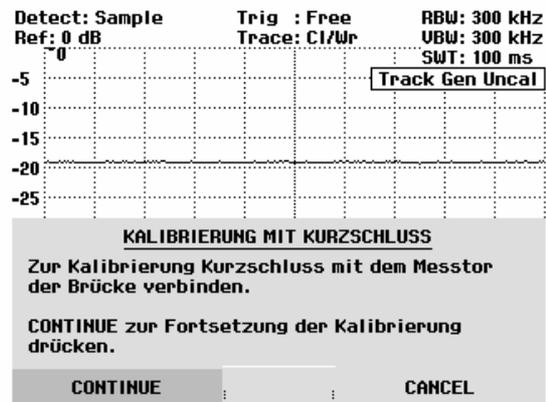
Während des Kalibriervorgangs meldet der R&S FSH "Kalibrierung Kurzschluss, bitte warten...". Mit den Softkeys CANCEL kann der Kalibriervorgang abgebrochen werden.
