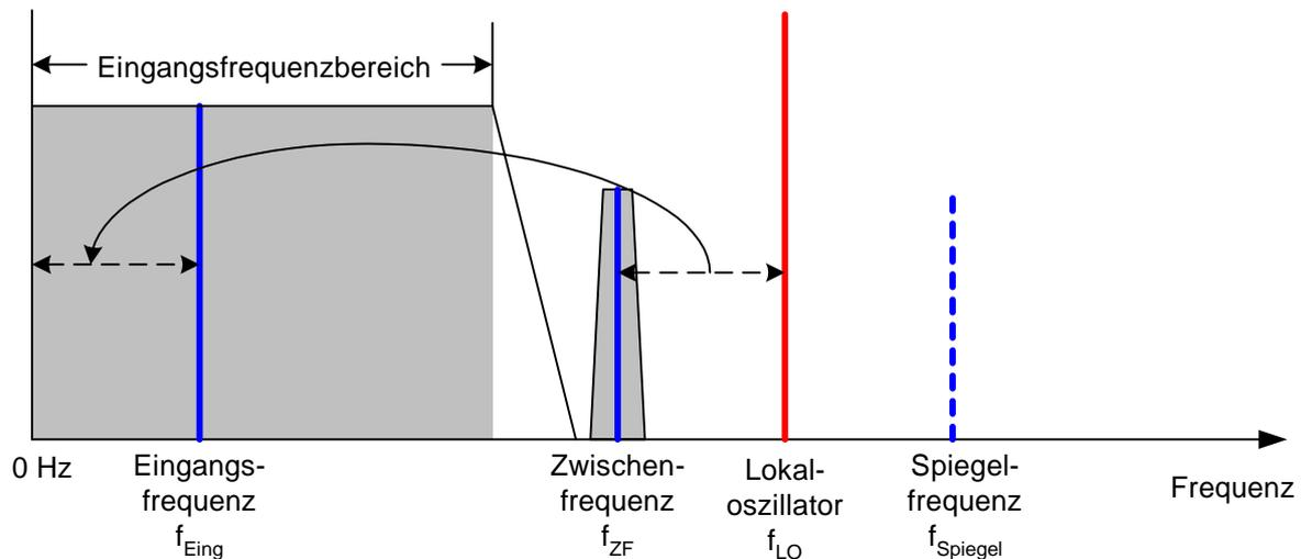
Die Abstimmung des 1. Lokaloszillators erfolgt über eine Sägezahnspannung, die gleichzeitig als x-Ablenkspannung für das Display dient. Die praktische Realisierung nutzt die Synthesizertechnik zur Erzeugung der Frequenz des ersten Lokaloszillators und ein digitales Display zur Anzeige.
