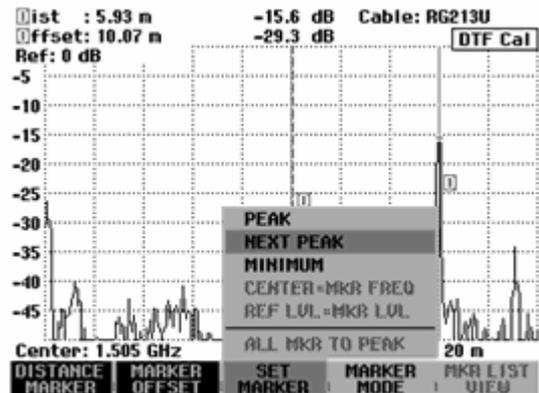
Für eine höhere Auflösung der Kabelfehlstellen ist eine Zoom-Funktion verfügbar. Damit sind vor allem bei langen Kabeln eng beieinander liegende Fehlstellen besser unterscheidbar.
