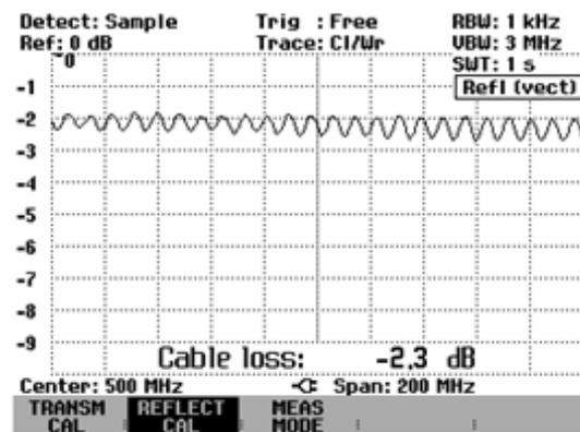
Die Kabeldämpfung berechnet der R&S FSH aus dem Mittel aus Maximalwert und Minimalwert der dargestellten Messkurve. Sie ist daher als Mittelwert innerhalb des dargestellten Frequenzbereichs zu verstehen.
