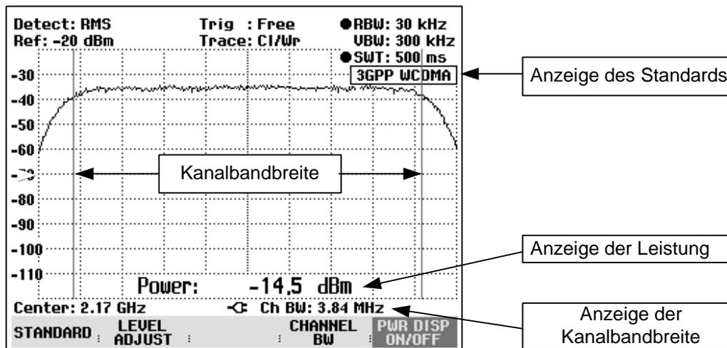
In der Grundeinstellung ist die Leistungsmessung für 3GPP W-CDMA Signale eingestellt.
