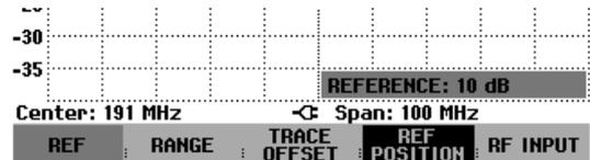
Bei Messungen an Verstärkern ist darauf zu achten, dass der R&S FSH nicht übersteuert wird. Dies ist dann sichergestellt, wenn die Messkurve sich innerhalb des Bildschirmrasters befindet (bei REF POSITION = 0 dB und TRACE OFFSET = 0 dB).
