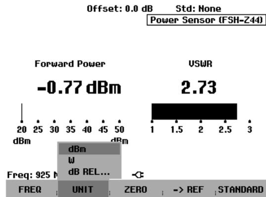
Bei Wahl der Einheit dB REL... öffnet der R&S FSH das Werteingabefeld für den Bezugspegel.
