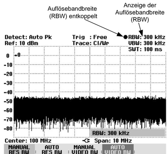
*Hinweis: Die 200-kHz-Bandbreite ist immer mit den Zifferntasten einzugeben. Bei Auswahl der Bandbreite mit dem Drehrad oder den Cursor-Tasten überspringt der R&S FSH die 200-kHz-Bandbreite.*
