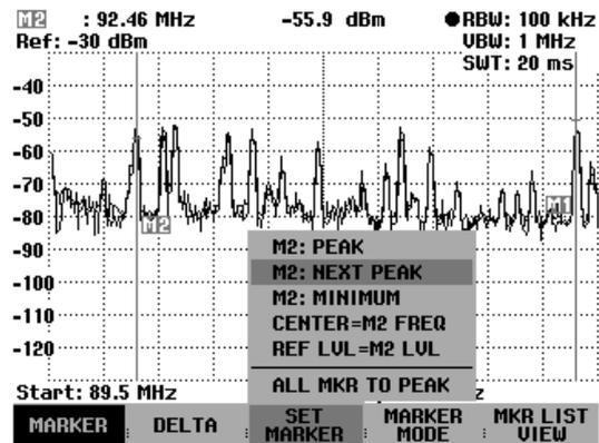
Zusätzlich ist die Positionierung aller eingeschalteten Marker (M1...M6) auf die Maxima einer Messkurve möglich.
