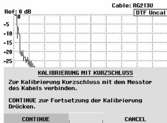
Während der Kurzschlusskalibrierung meldet der R&S FSH "Kalibrierung mit Kurzschluss, bitte warten...".
