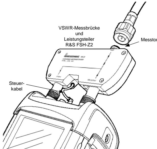
Der R&S FSH kann sowohl die Rückflussdämpfung als auch das VSWR eines Messobjekts anzeigen.
