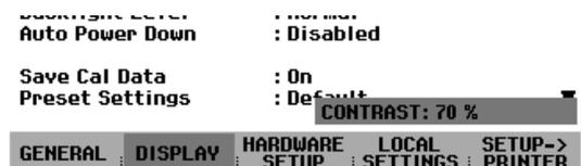
Der R&S FSH zeigt die Einstellung in der Zeile "Display Contrast" in der Übersicht der Setup-Einstellungen an.
