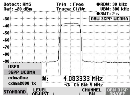
Mit der Auswahl von USER stellt der R&S FSH die zuletzt mit USER verwendete Einstellung für die Messung der belegten Bandbreite wieder ein. Änderungen in den Einstellungen übernimmt er automatisch, so dass sie beim nächsten Aufruf des Standards USER wieder verfügbar sind.
