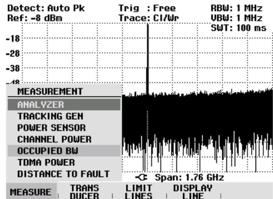
Der R&S FSH zeigt das Softkeymenü zur Einstellung zur Messung der belegten Bandbreite an. Im Messdiagramm zeigt er durch zwei senkrechte Linien die belegte Bandbreite an. Den numerischen Messwert (OBW) zeigt er im Messwertdiagramm unten groß an.
