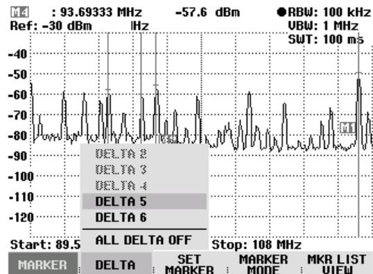
*Hinweis: Wenn der Marker 1 (M1) ausgeschaltet wird, schaltet der R&S FSH auch alle Delta-Marker aus, da sich alle Delta-Marker auf den Marker 1 beziehen.*
