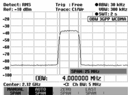
Der größte zugelassene Frequenzdarstellbereich bei der Messung der belegten Bandbreite ist das Zehnfache der Kanalbandbreite. Bei größeren Frequenzdarstellbereichen wäre das Ergebnis der Kanalleistungsmessung zunehmend ungenau, da zu wenige Punkte der Messkurve in den zu messenden Kanal fallen.
