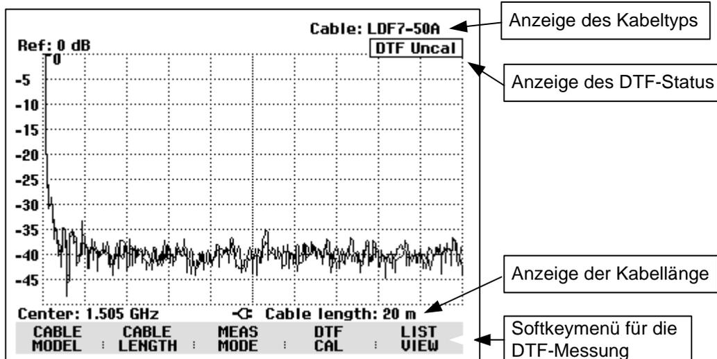
Zur Durchführung der Kabelfehlstellenmessung braucht der R&S FSH die Information über den zu messenden Kabeltyp und die ungefähre Länge des Kabels.
