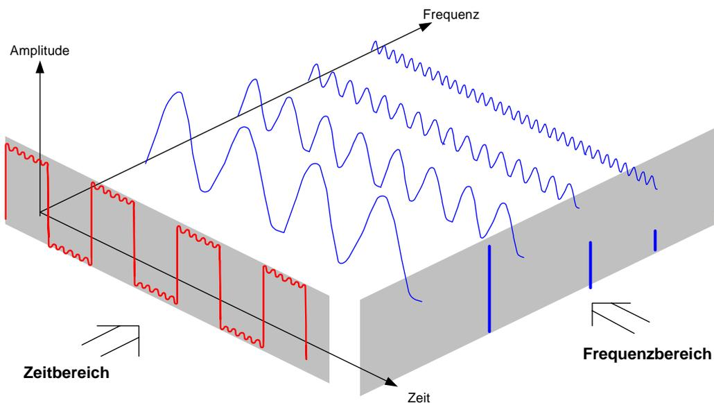
Das periodische Rechtecksignal im Zeitbereich kann mit Hilfe der Fouriertransformation in den Frequenzbereich transformiert werden. Im Falle eines Rechtecksignals treten dabei die Grundwelle (= Frequenz des Rechtecksignals) und deren ungerade Harmonische auf. Der Spektrumanalysator misst mit einem schmalbandigen Bandpassfilter im Frequenzbereich. Nur bei Frequenzen, bei denen ein Signal vorhanden ist, ergibt sich dabei eine Anzeige, die der Amplitude des jeweiligen Frequenzanteils entspricht.
