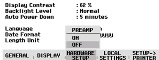
Der R&S FSH wechselt in das Untermenü zur Konfiguration des Vorverstärkers. Der Auswahlbalken zeigt auf die aktuelle Einstellung.
