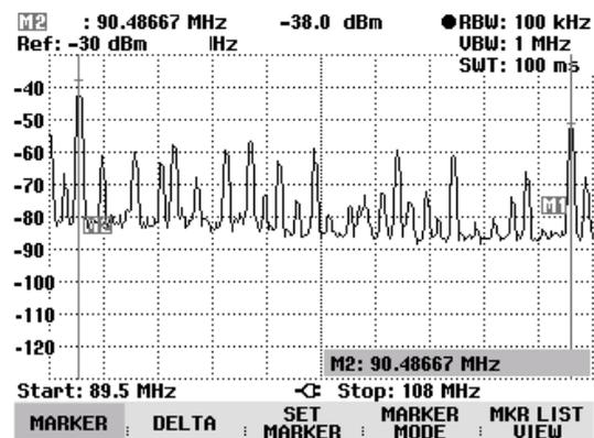
Der R&S FSH zeigt den zuletzt editierten Marker oder Delta-Marker im Marker-Ausgabefeld oben links am Bildschirm an. Alle Markerfunktionen im Menü SET MARKER beziehen sich auf die angezeigten Marker.
