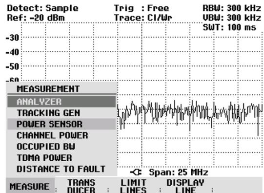
Der R&S FSH öffnet den Bildschirm für die Leistungsmessung. Wenn kein Leistungsmesskopf angeschlossen ist, zeigt er keinen Messwert an. Wenn ein Leistungsmesskopf angeschlossen ist nimmt er über die Schnittstelle Verbindung zum Leistungsmesskopf auf und zeigt nach einigen Sekunden die gemessene Leistung an.
