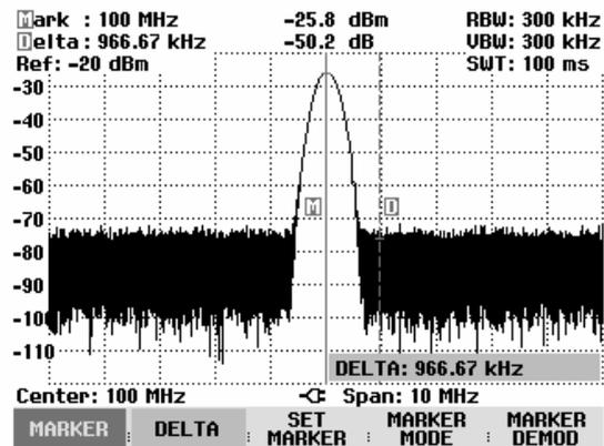
**Automatische Positionierung des Markers**
